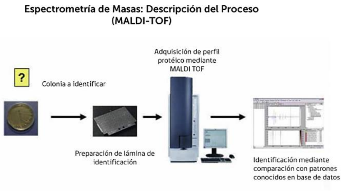
Figura 15. Descripción del procedimiento para identificación bacteriana con tecnología MALDI-TOF.
