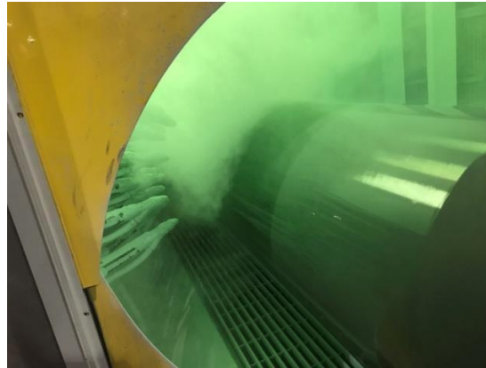
Figura 4. Aplicación de epoxi en una empresa estadounidense
