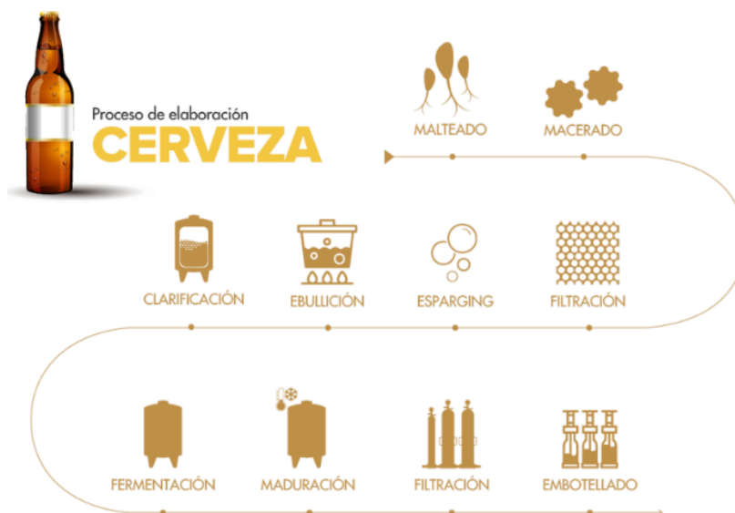
Figura 3 – Proceso de producción de cerveza ( https://www.invia1912.com/soporte/procesos-elaboracion/cerveza/ , Agosto 2025)
