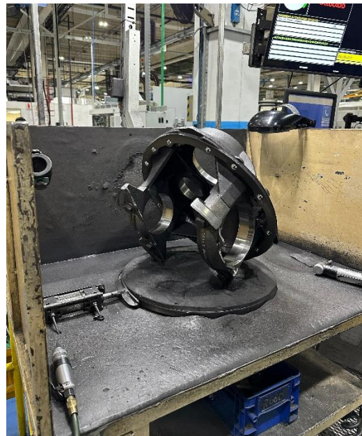
Figura 12: Pieza descargada en mesa de rebabado
