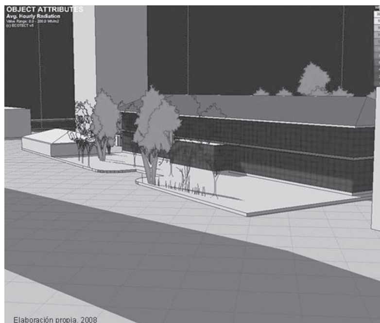
Fig. N° 9: modelamiento computacional de la radiación incidente de la fachada Suroeste.
