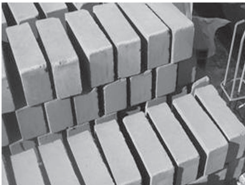
Fig. N° 4b: mampuesto de suelo-cemento.
