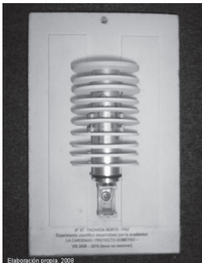
Fig. N° 10: Datalogger de radiación solar.
