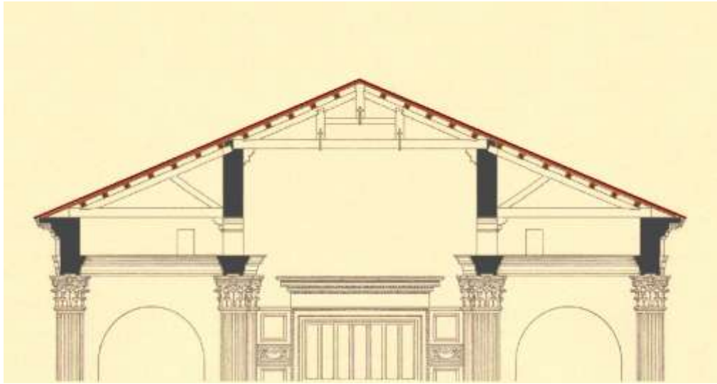
Fig.04: Panteón de Agripa (126 D.C.), parte central del Pronaos o Pórtico de entrada presenta una “falsa cercha”. En los laterales se ven incipientes cabriadas.
