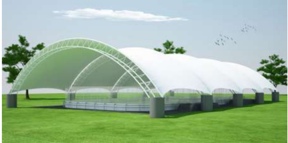
Fig.42: Arcos ligeros empotrados en los apoyos, con cubierta textil
