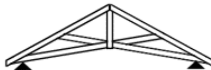
Fig.10: Cercha tijera, cordón inferior inclinado
