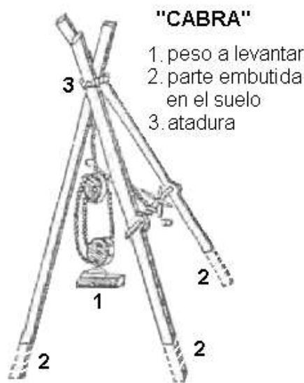
Fig.01: Cabra, armazón auxiliar para levantar objetos
