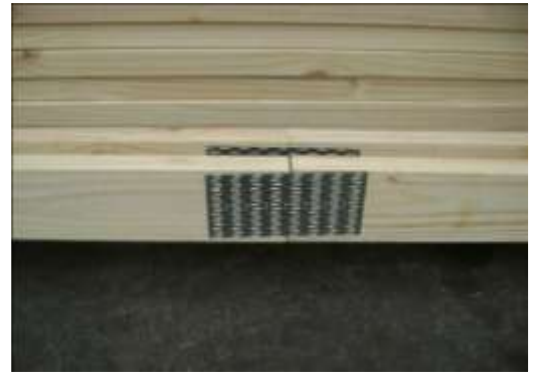
Fig.21: Plancha cavada uniendo dos maderas.
