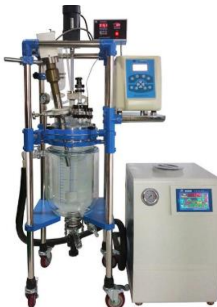
Figura 11: Esquema de un equipo de extracción asistida por ultrasonidos (SCIENTZ, s.f.)
