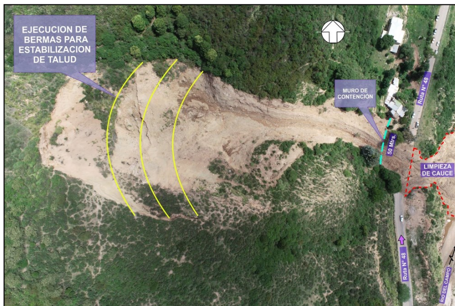
Foto IV.1: Se observa la magnitud del deslizamiento ocurrido en diciembre de 2023 y las obras proyectadas a realizar por los organismos provinciales y municipales con objeto de estabilizar el deslizamiento en el área de El Lindero. Fuente: https://www.elancasti.com.ar/informacion-general/realizan-obras-contencion-y-prevencion-el-lugar-del-derrumbe-aconquija-n542303
