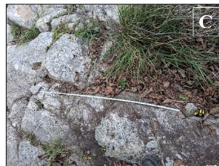
Fotos V.3: Determinación, con la ayuda de una cinta métrica, de discontinuidades en tres direcciones (A, B, C) para la apreciación del RQD en migmatitas del río de Las Cañas aflorantes en las inmediaciones del área de cierre. Fotos: mayo de 2025.
