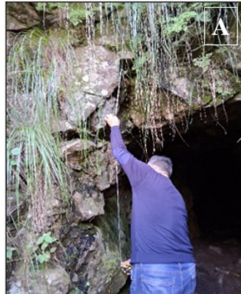
Fotos V.2: Determinación, con la ayuda de una cinta métrica, de las discontinuidades en tres direcciones (A, B, C) para la apreciación del RQD en las paredes del macizo rocoso aflorante en la entrada del Túnel 5. Fotos: mayo de 2025.
