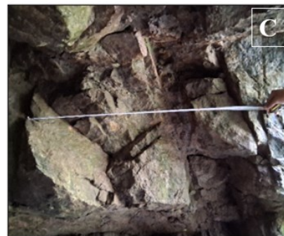
Fotos V.2: Determinación, con la ayuda de una cinta métrica, de las discontinuidades en tres direcciones (A, B, C) para la apreciación del RQD en las paredes del macizo rocoso aflorante en la entrada del Túnel 5. Fotos: mayo de 2025.
