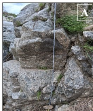
Fotos V.3: Determinación, con la ayuda de una cinta métrica, de discontinuidades en tres direcciones (A, B, C) para la apreciación del RQD en migmatitas del río de Las Cañas aflorantes en las inmediaciones del área de cierre. Fotos: mayo de 2025.
