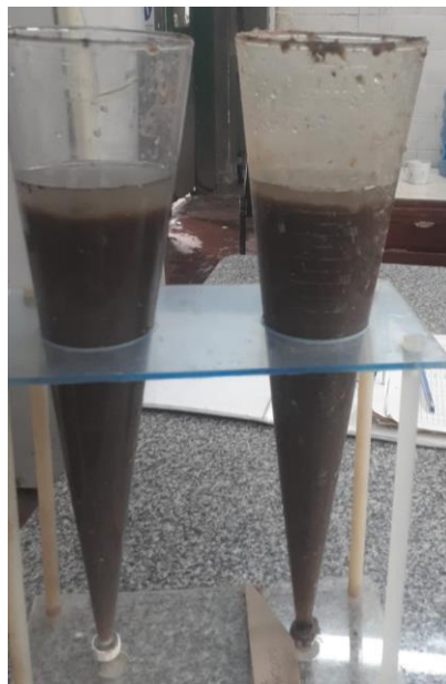
Figura 2.2: Conos Imhoff con efluente liquido usados para realizar ensayo de Solidos Sedimentables (SS)
