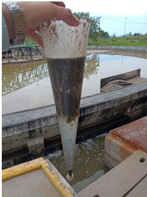
Figura 2.22: Flotación de sólidos en Clarificador a causa de aumento de pH
