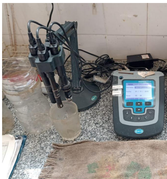
Figura 2.4: Equipo Hach HQ 440d multi donde se observa sondas de medición de Conductividad, sonda de Temperatura y sonda de Oxígeno Disuelto
