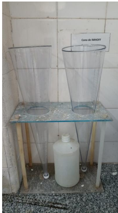
Figura 2.1: Conos Imhoff usados para realizar ensayo de Solidos Sedimentables (SS)
