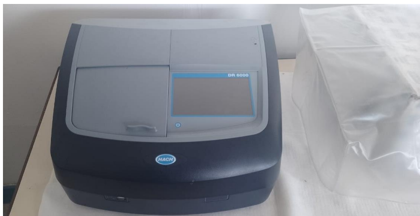
Figura 2.5: Espectrofotómetro Hach DR 6000 usado para ensayo de DQO
