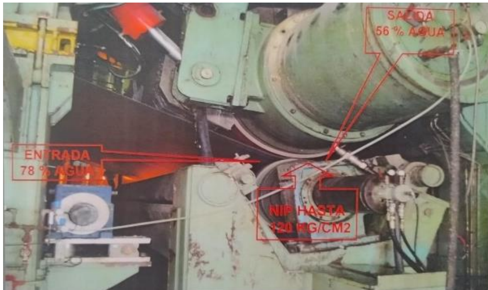
Figura 3.7: Zona de prensas de máquina de papel (Recopilada de información interna de planta)
